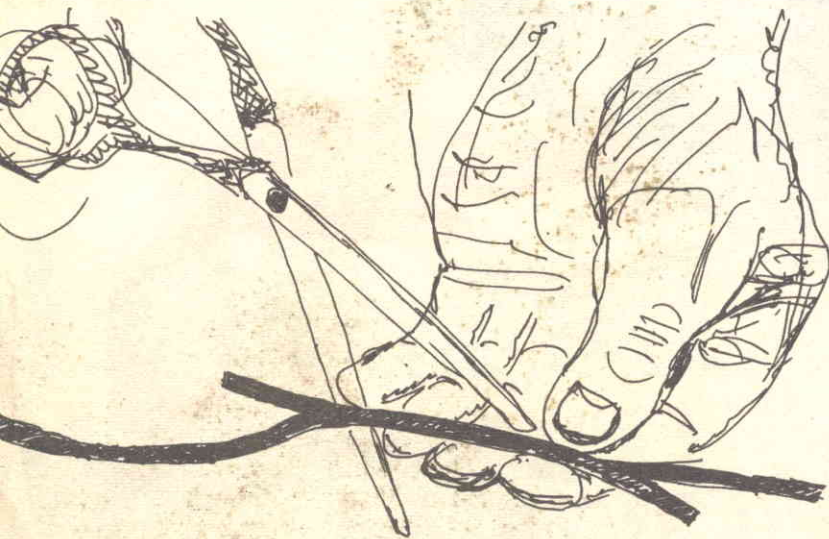
Modo corretto per tagliare due spezzoni di nastro sovrapposti, in modo che i tagli diagonali siano perfettamente simmetrici fra loro.
